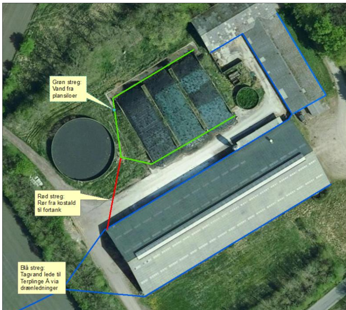
Figur 4. Afløbsplan for spildevand.
